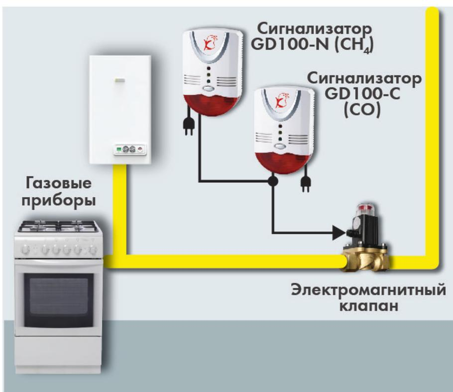
Сигнализатор Кенарь GD100-N следует устанавливать на вертикальной стене в местах возможной утечки газа (вблизи газовых плит, газовых нагревательных и отопительных приборов, вентилях, клапанов и т.д.) на расстоянии 300-500 мм от потолка, сигнализатор Кенарь GD100-C следует устанавливать на вертикальной стене на расстоянии не менее 1,8 м от пола и не менее 300 мм от потолка. По горизонтали прибор должен располагаться на расстоянии от 2х до 4х метров от возможного источника газа.
