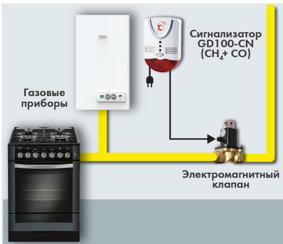
**Сигнализатор следует устанавливать** на вертикальной стене в местах возможной утечки газа (вблизи газовых плит, газовых нагревательных и отопительных приборов, вентилях, клапанов и т.д.) на расстоянии 300-500 мм от потолка. По горизонтали прибор должен располагаться на расстоянии от 2х до 4х метров от возможного источника газа.
