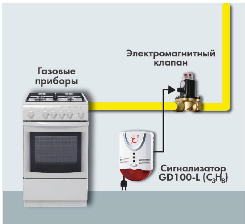
**Сигнализатор следует устанавливать** на вертикальной стене ниже мест возможной утечки газа (вблизи газовых плит, газовых нагревательных и отопительных приборов, вентилях, клапанов и т.д.) на расстоянии не более 250 мм от пола. По горизонтали прибор должен располагаться на расстоянии от 2х до 4х метров от возможного источника газа.
