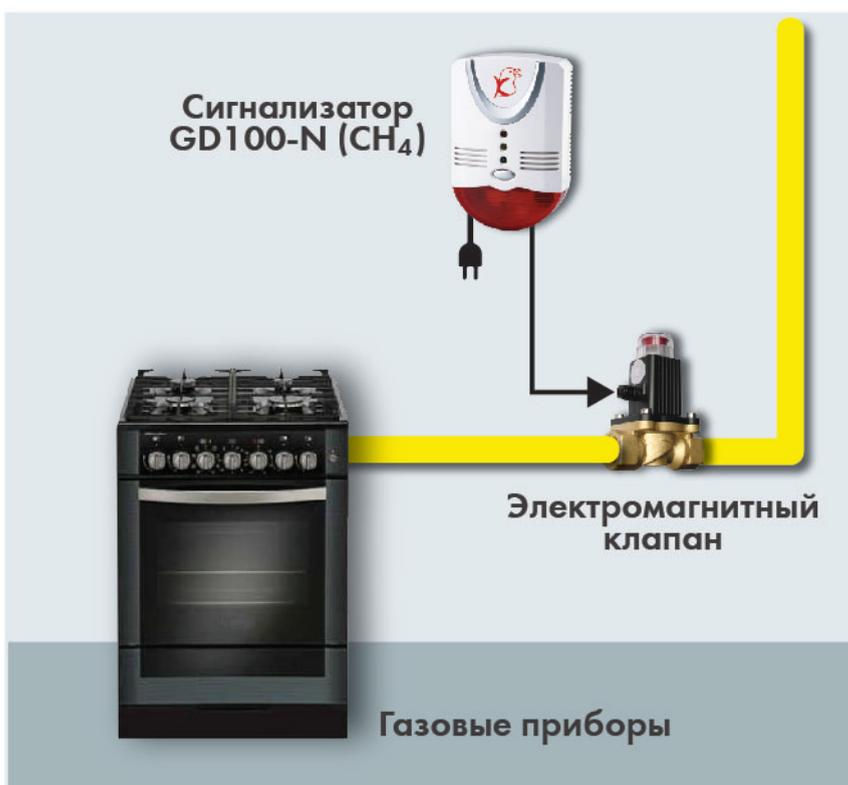
**Сигнализатор следует устанавливать** на вертикальной стене в местах возможной утечки газа (вблизи газовых плит, газовых нагревательных и отопительных приборов, вентилях, клапанов и т.д.) на расстоянии 300-500 мм от потолка. По горизонтали прибор должен располагаться на расстоянии от 2х до 4х метров от возможного источника газа.
